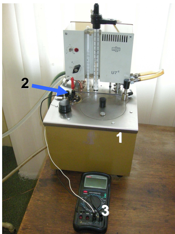
Rys. 3. Zestaw pomiarowy: ultratermostat (1), płytki (2) z zamocowanym termometrem oporowym i termistorem, omomierz cyfrowy (3)
